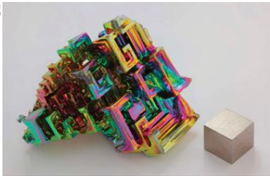
*Cristal oxydé de bismuth artificiel aux côtés d'un cube de bismuth pur.*
